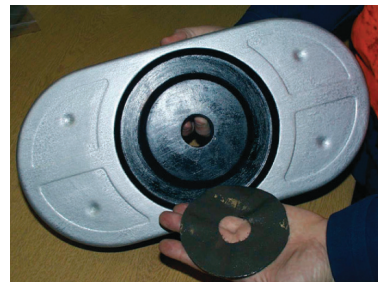
Apply seal «wet side first» onto spigot
